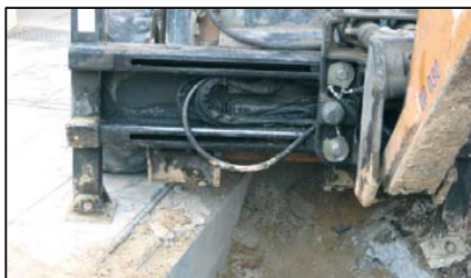
Apoyo sobre dos superficies de diferentes resistencias.
